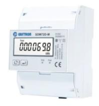
Medidor digital para tres fases y cuatro hilos, que mide energía activa, reactiva y potencia, soportando hasta 100 A de corriente directa. Incluye comunicación Modbus RTU y es adecuado para aplicaciones residenciales, fotovoltaicas, industriales y de servicios públicos.
