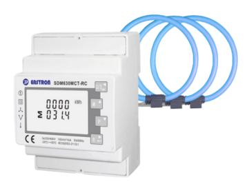
Analizador que mide energía activa, reactiva, corriente, voltaje, potencia, entre otros parámetros. Compatible con bobinas Rogowski de hasta 5000 A, incluve comunicación Modbus RTU y soporta conexión trifásica a 3 y 4 Montaje en riel DIN y hilos. adecuado para diversas aplicaciones de monitoreo energético.
