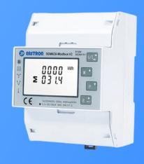
Analizador de redes que mide energía activa, reactiva, corriente, voltaje, potencia y más. Soporta hasta 100 A de corriente directa, tiene comunicación Modbus RTU y es adecuado para aplicaciones residenciales, industriales y fotovoltaicas. Montaje en riel DIN.
